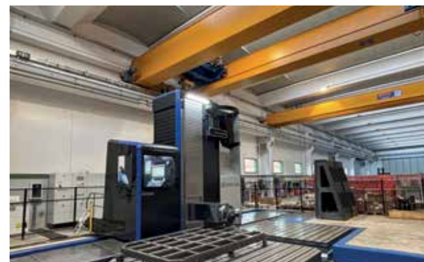
La fresatrice a montante mobile FP 14000 da 14 metri di corsa longitudinale installata presso Officine della Gavarnia
