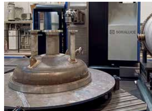
FP 14000 consente di lavorare completamente un pezzo senza la necessità di riattrezzarlo per operare su più facce
