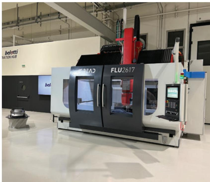
Un centro di lavoro nesting per lastre in alluminio e un centro di lavoro ibrido Bead per stampa 3D e fresatura CNC installati nell'HUB.
